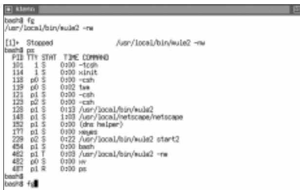
画面2 Muleのプロセスを一時停止させてUNIXコマンド利用中
